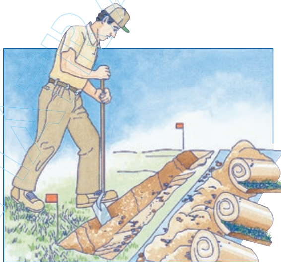
Először óvatosan emeljük ki a gyep téglákat, majd ássuk az árkot 25-30 cm mélyre
